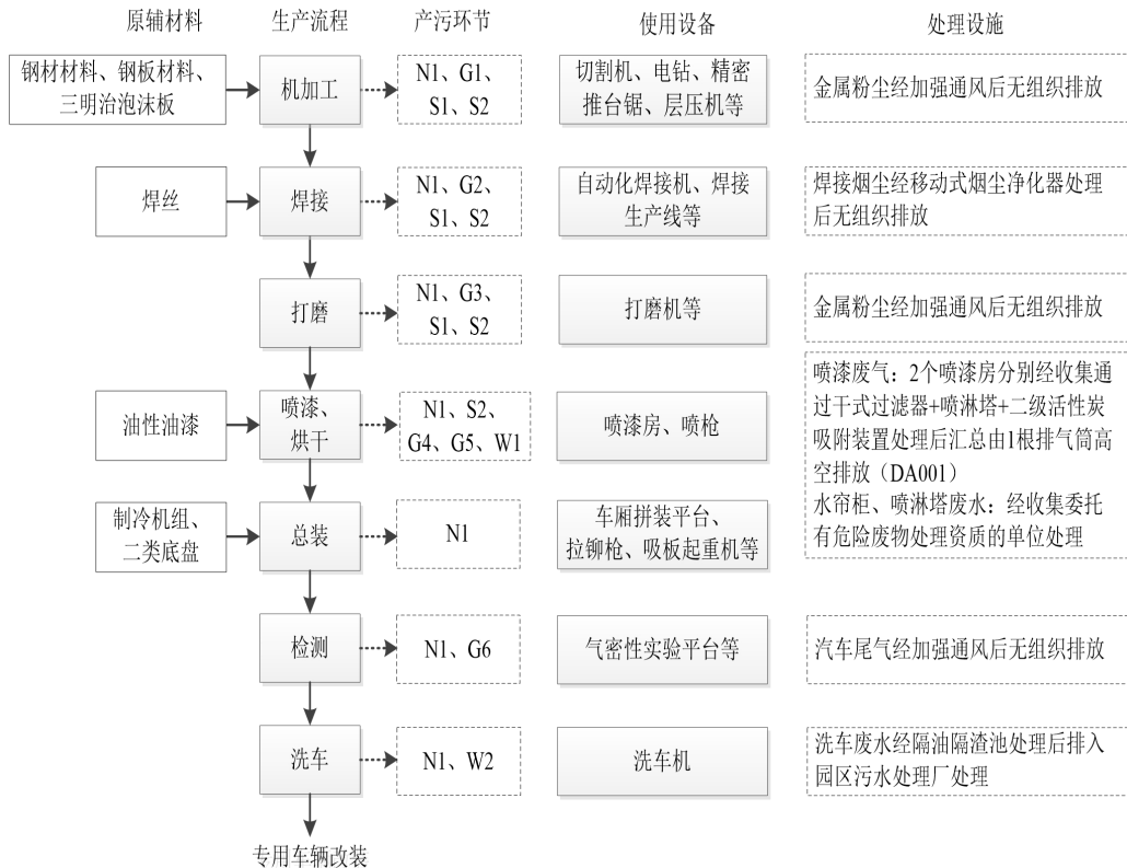
图 2-3 专用车辆改装生产工艺流程图
